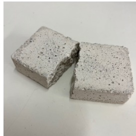
Abb. 8 Bruchtest Probewürfel Quelle Joel Keller
