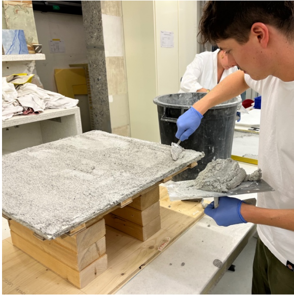
Abb. 17 erste Mörtelschicht des zweiten Trägers Quelle Joel Keller
