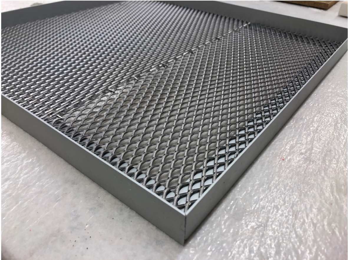
Abb. 22 Die Streckmetallplatte wurde auf dem Alurahmen befestigt. In einem nächsten Schritt würde die Streckmetallplatte mit Rahmen von hinten an den abgebundenen Mörtel der abgenommenen Wandmalerei (Dummi) geklebt werden.
