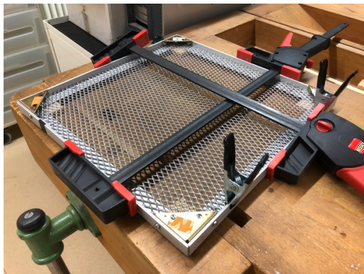
Abb. 12 Zusammenbau des Alurahmens für den Dummie.
