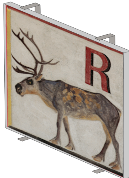
Abb. 3 Visualisierung von Ledergerber des vorgeschlagenen Rahmens und des Befestigungssystems
