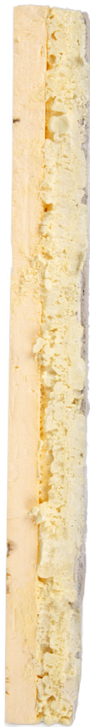
Abb. 7 Aufnahme des Querschnittes des Objektes mit dem Facing. Von rechts nach links: den originalen Intonaco erkennt man leicht auf der Oberseite (grau), während man die Malschicht und das Facing (Gaze und Cyclododecan) nicht erkennen kann. Es folgt der PU-Schaum und als Abschluss eine Styroporplatte, welche zusammen das starre Facing ausmachen. Die Aufnahme wurde zur Vereinfachung der Situation der Schemadarstellung in Abb. 8 nachempfunden und vertikal gezeigt. In situ würde am rechten Rand die Mauer ansetzen.
